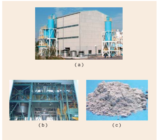
中部電力株式会社の碧南火力発電所に納入した人工ゼオライト製造プラント(生産能力:3,000 t/年)の外観(a)、建屋内(b)、および粉末ゼオライト(c)
