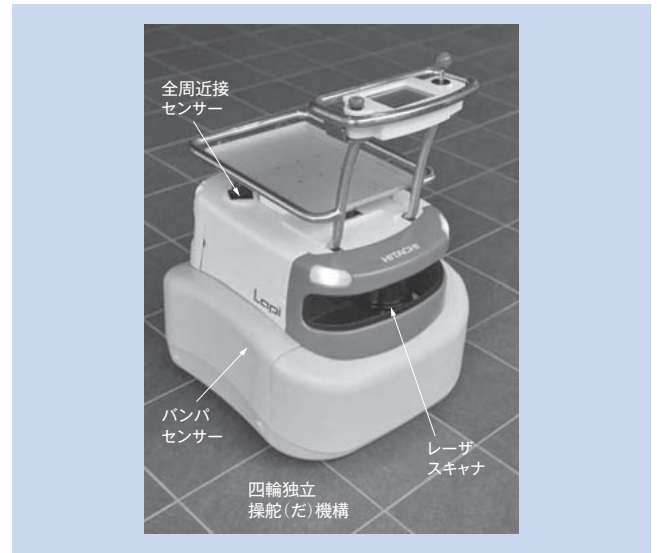
図7 | 物流支援ロボットの外観 誘導ラインなどのインフラを必要としないことを特徴としている。工場のラインや物流センターでの適用を計画中である。
