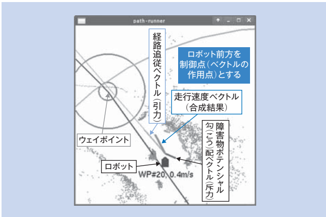
図6 | 障害物回避制御 障害物から斥力、ウェイポイントから引力をそれぞれ仮定し、その合力方向にロボットを誘導して障害物回避走行を行う。
