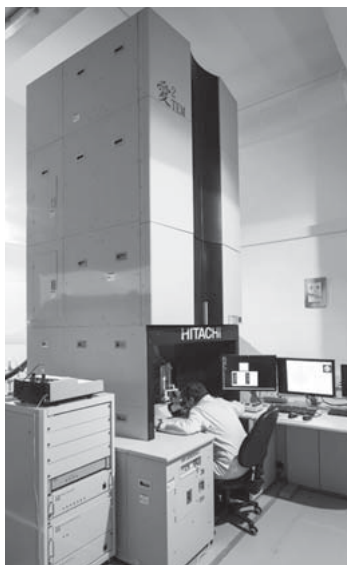
図2 | 球面収差補正器を搭載したFE-TEM
