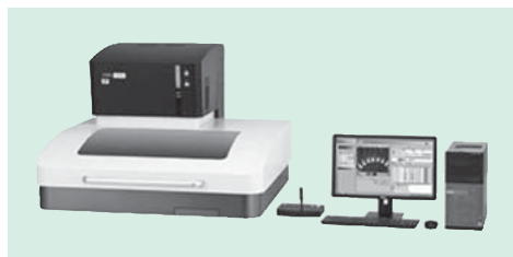
図16 | 高性能蛍光X線膜厚計FT150シリーズ スマートフォンなどに用いる電子部品などのめっき膜厚を、非破壊で迅速に測定する。蛍光X線分析による測定を専用機化することで、最先端の生産現場での品質管理のニーズに応えている。
