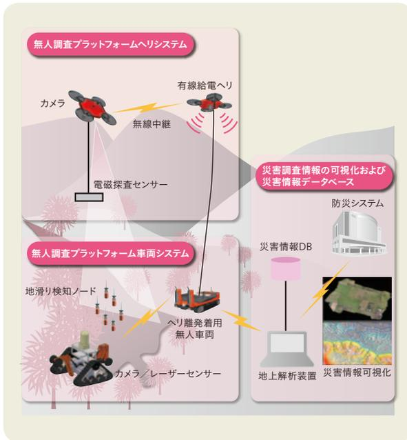
3 災害調査用地上／空中複合型ロボットシステムの概念
