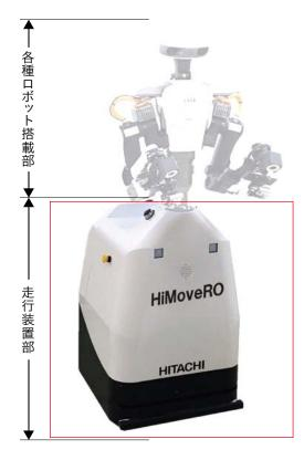
■カワダロボティクス株式会社製の双腕型ロボットを搭載した HiMoveRO
