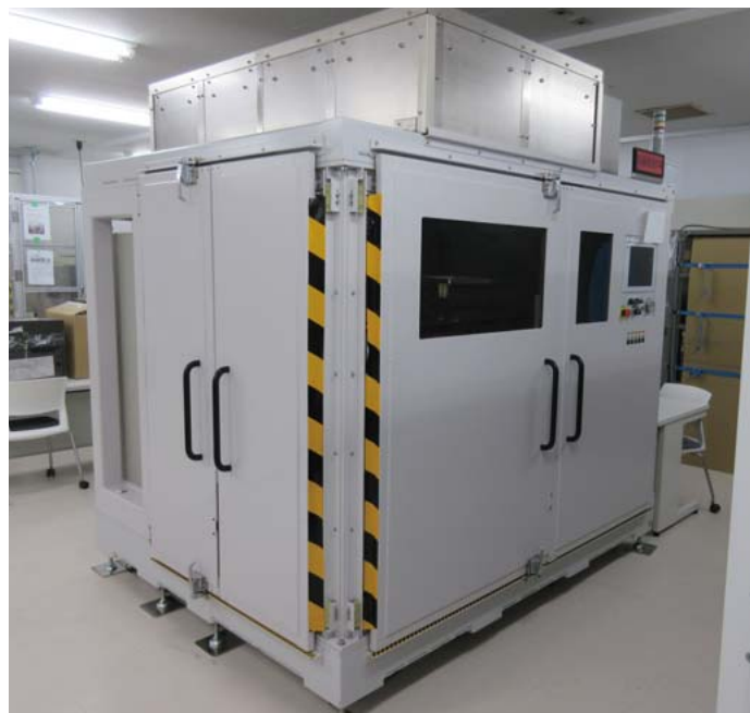
3 X線技術を活用した異物検査装置の評価・デモシステム(ステージタイプ)
