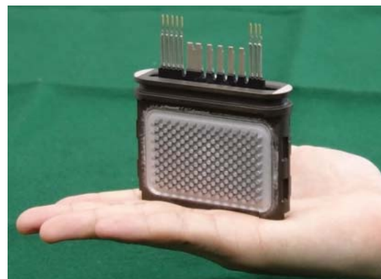
2 直接水冷型両面冷却パワーモジュール
