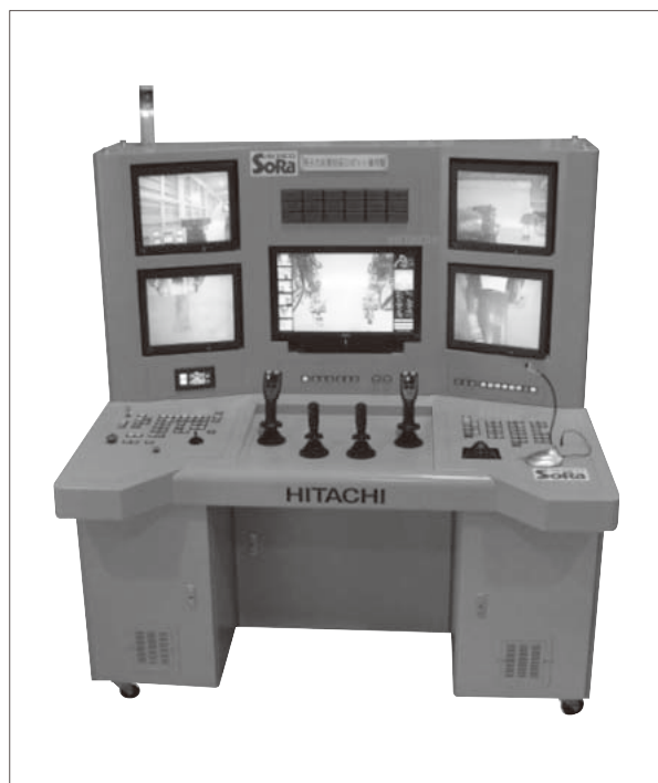
図2| 双腕重機ロボット「ASTACO-SoRa」の遠隔操作盤の外観
