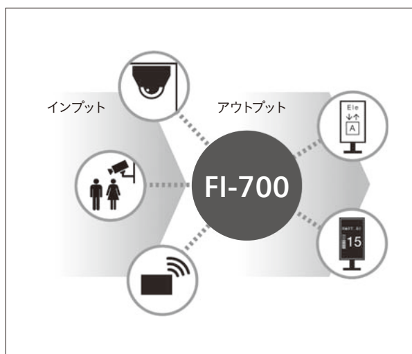
図7| 乗り場の監視カメラとデータ連携した応用運転の例
