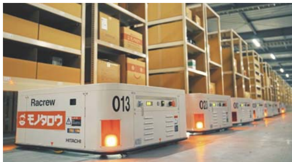
図2 | 株式会社MonotaROの 笠間ディストリビューションセンターで稼働中の 小型無人搬送ロボット「Racrew」
