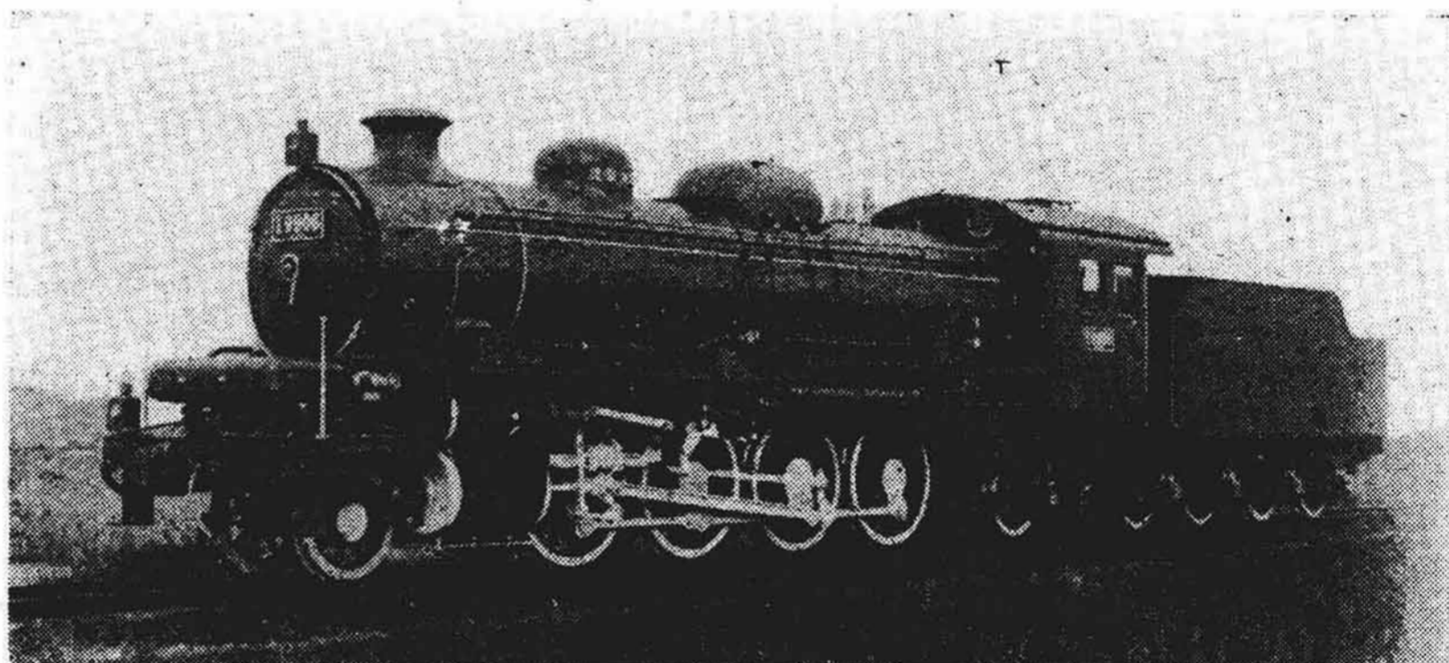
第七十七圖 鐵道省納2—8—2型過熱テンダー蒸汽機關車
