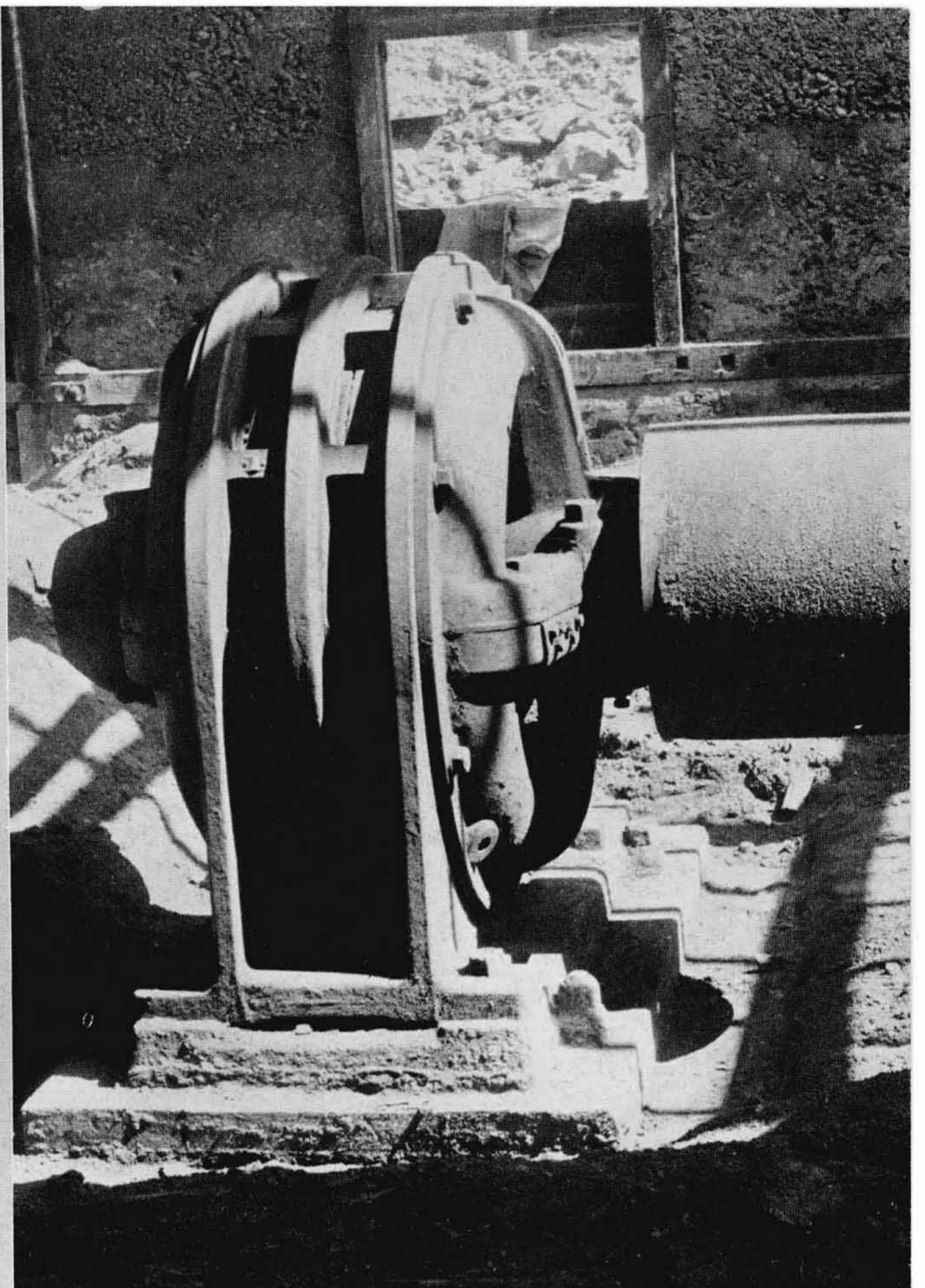
創業當時製作の日立鑛山用 200 HP 514 r.p.m. 三相誘導電動機(明治四十三
