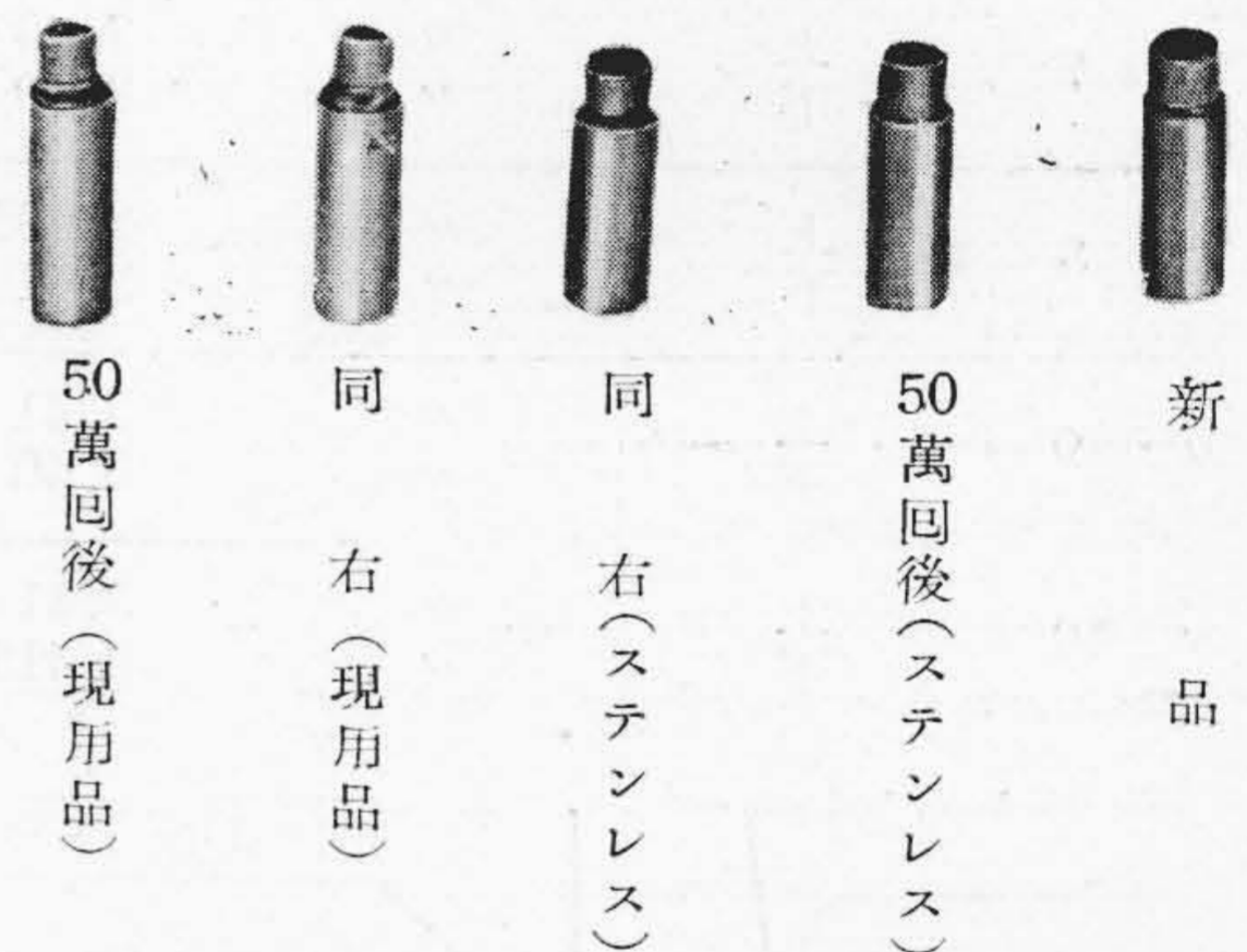
第9圖 ロータリーアーマチュアベアリングピン磨耗比較寫眞 Fig. 9 The Comparison of Wear of Rotary Armature Bearing Pin.
