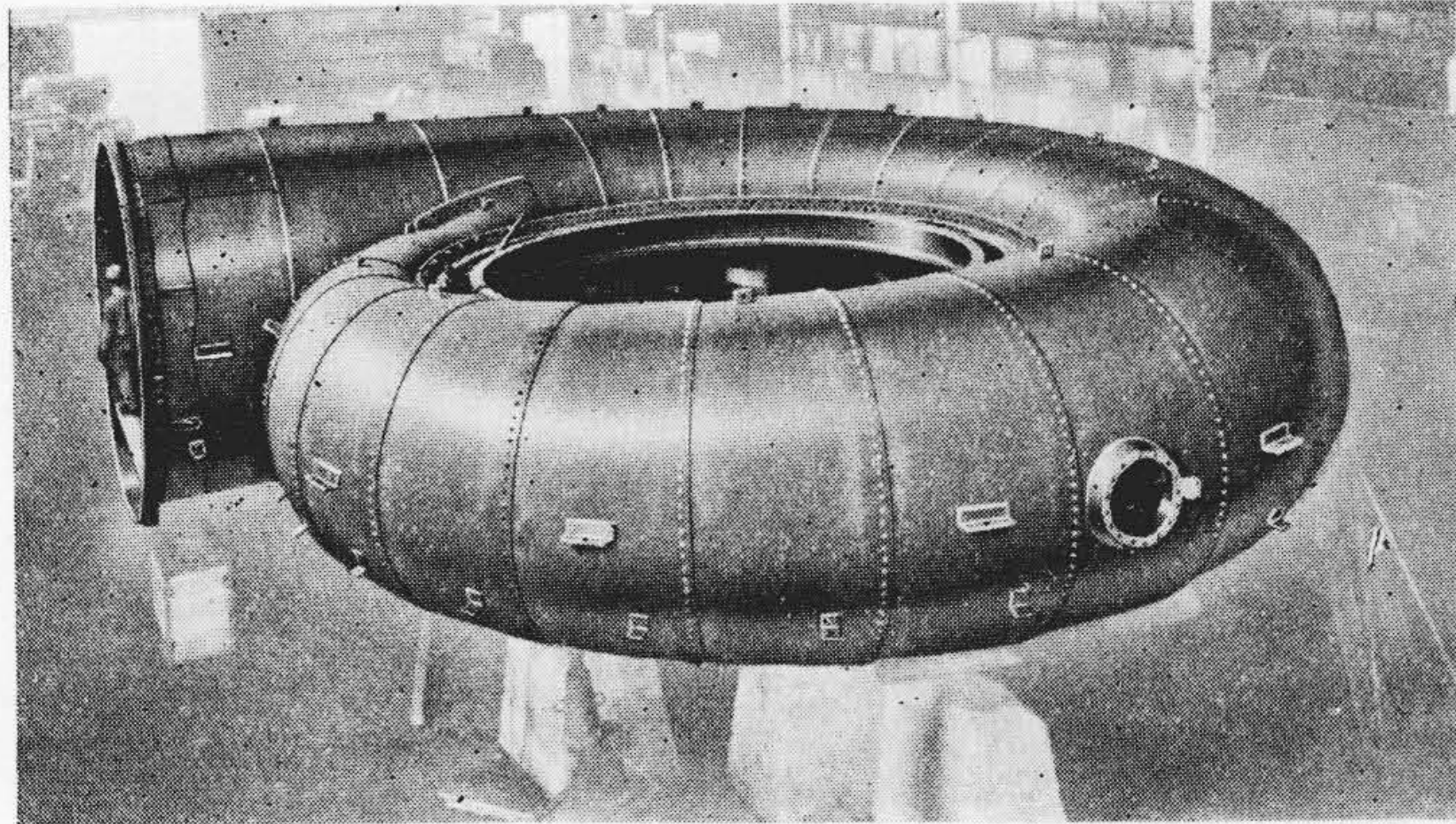
第 12 圖 スパイラルケーシングの工場組立 Fig. 12 Spiral Casing Assembled at the Works.
