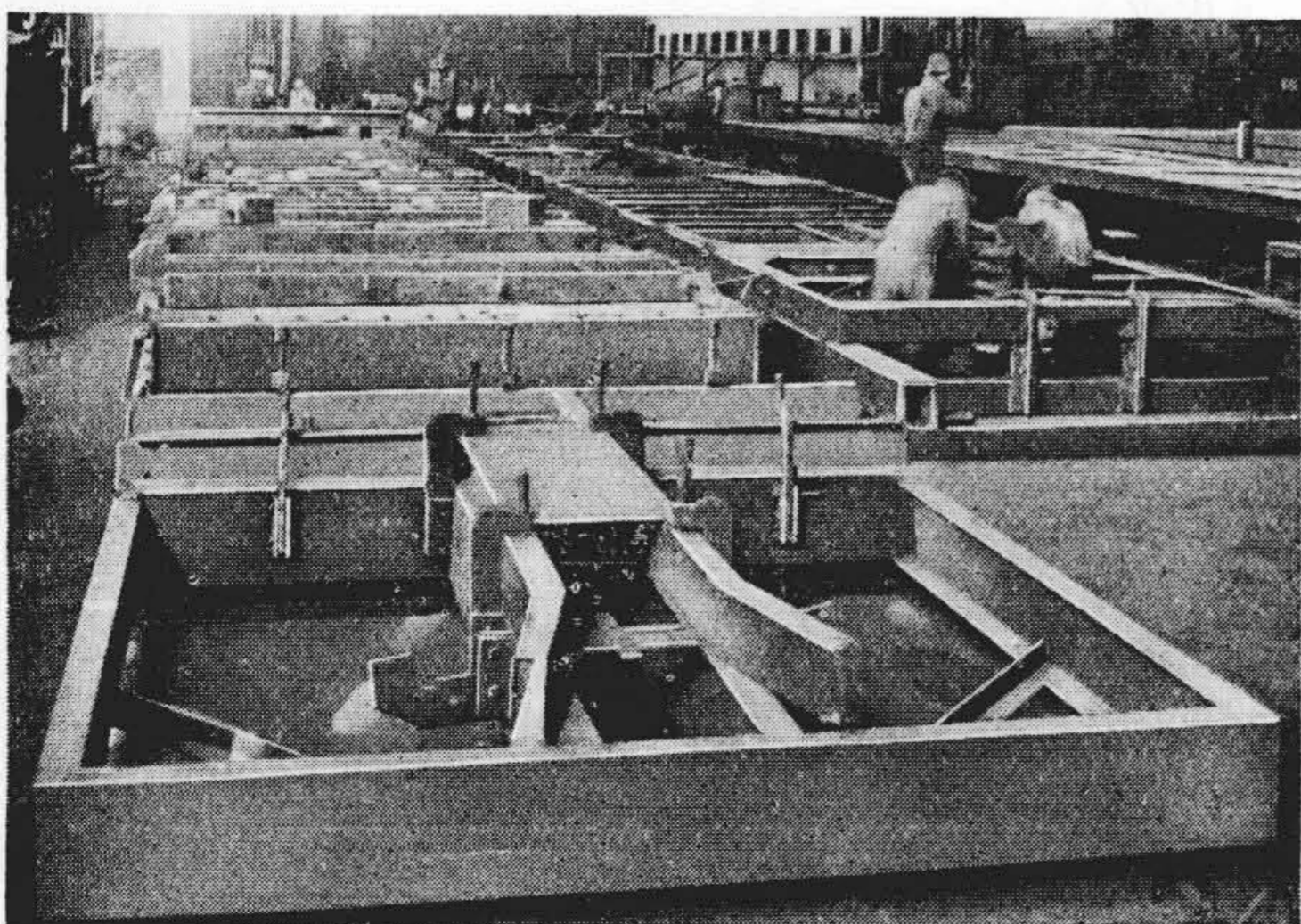
第 1 圖 臺枠第一治具作業状況 Fig. 1 States of Operation with the First Jig for Frame.
