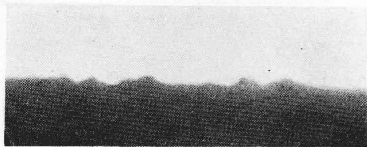
A WA-46-I 1 回研削 (ローラー成形) \times 175 被削材軟鋼切込 0.05 mm
