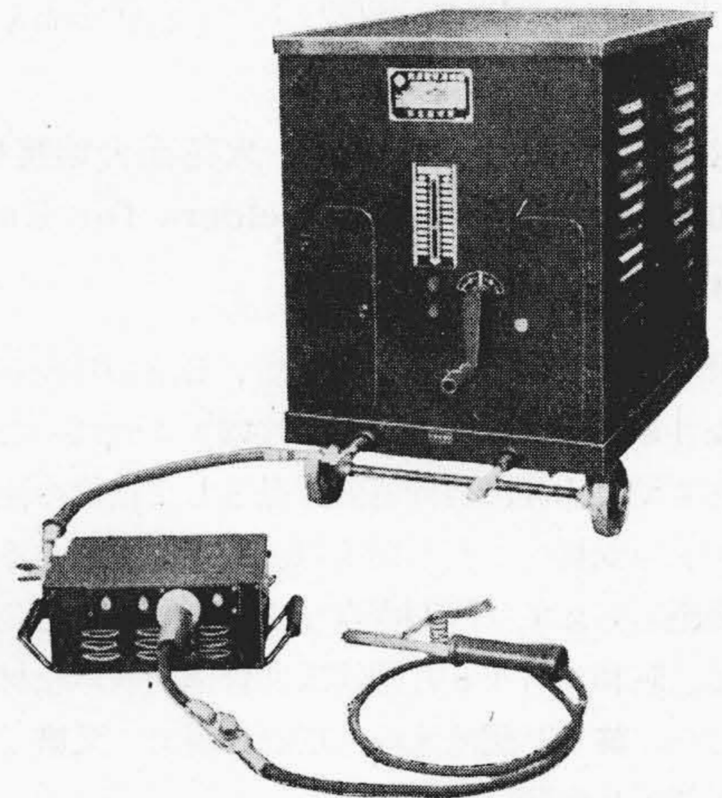
第 17 図 電流調整器と交流電弧熔接機 (上)交流電弧熔接機 (下)電流調整器 Fig. 17. Current Adjuster and A.C. Arc Welder (Up) A.C. Arc Welder (Down) Current Adjuster
