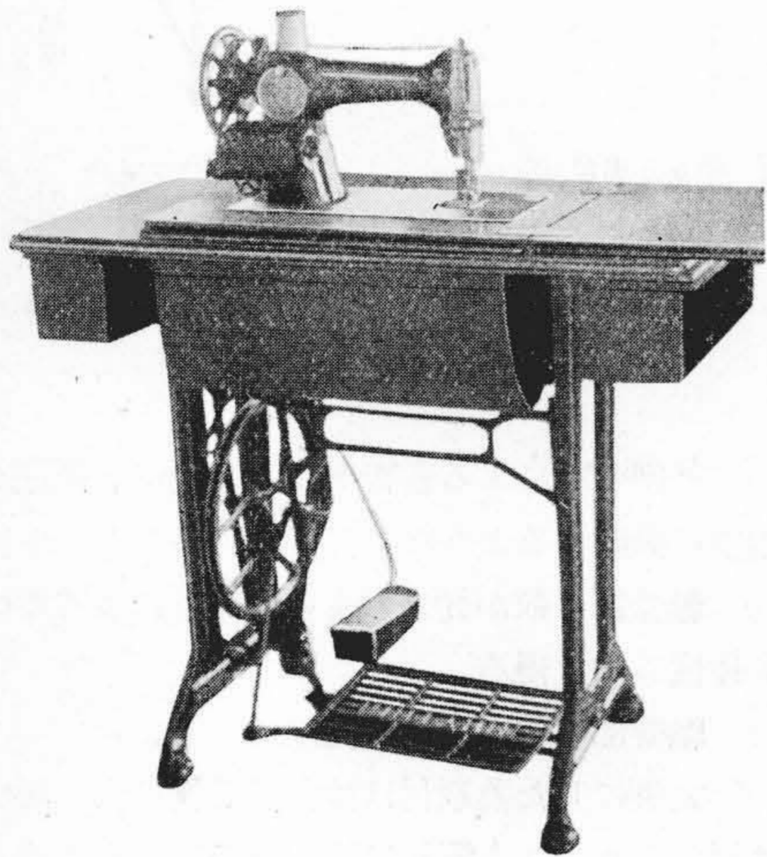
第 10 図 ミシンモーター及びコントローラー (HA-1 型足踏ミシンに取付けたる処) Fig. 10. Sewing Machine Motor and Controller, Applied to Type HA-1 Foot-Operated Sewing Machine
