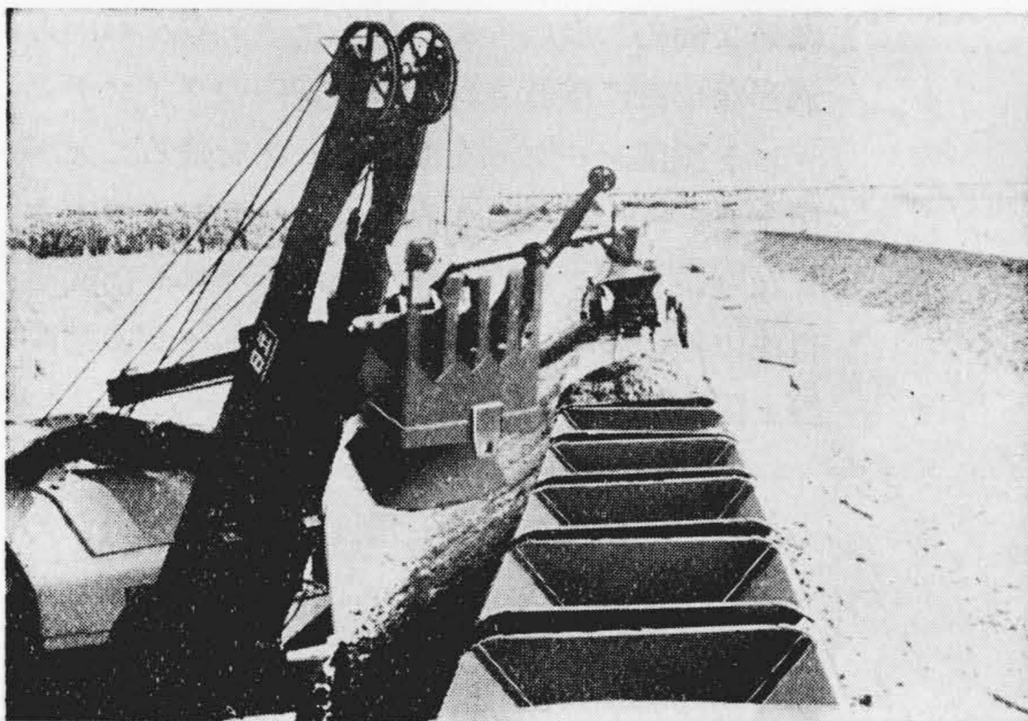
第 1 図 稼働中の U 06 型日立万能土掘機ショベル装架 UL 06
