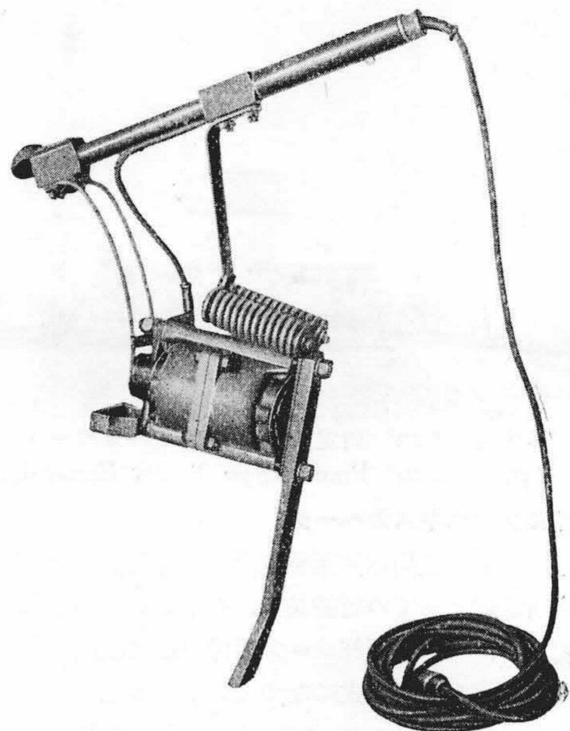
第9図 タイタンパー Fig. 9. Electric Tie Tamper
