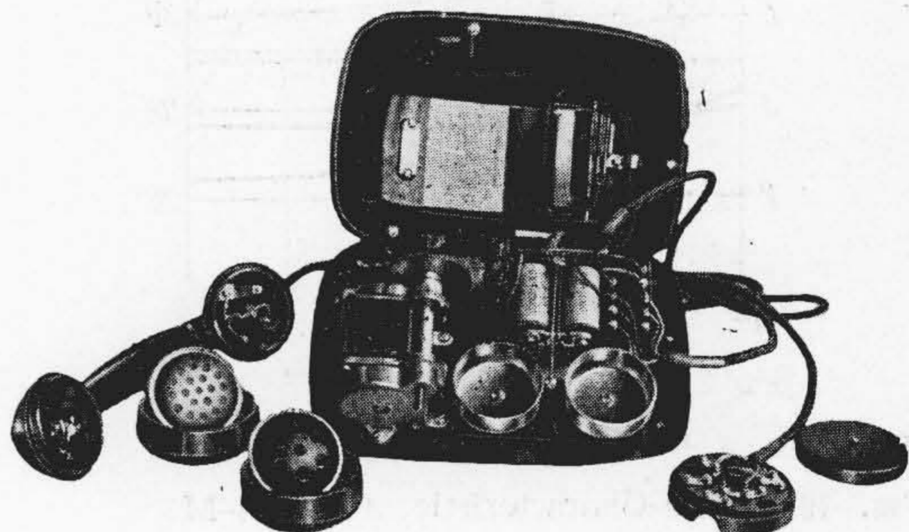
第 17 図 4 号 M 磁石式電話機内部 Fig. 17. No. 4-M Magneto Telephone Set Disassembled
