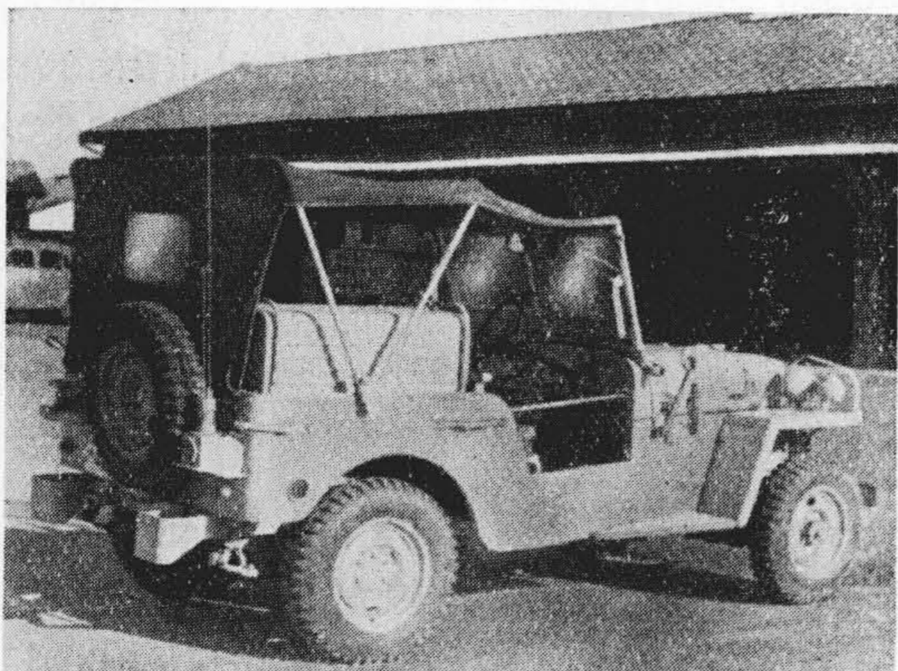
第 28 図 横浜市警ジープに装備された 150 MC VHF/FM 移動用無線電話装置の外観
