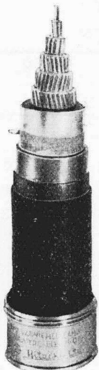
第 36 図 11 kV 0.75 in 2 × 1 c カンブリ ック絶縁鉛被編組ケーブル Fig. 36. 11 kV Grade Varnished, Cambric Insulated Lead Sheathed and Braided Cable 1 coud. 0.75 sq. in.
