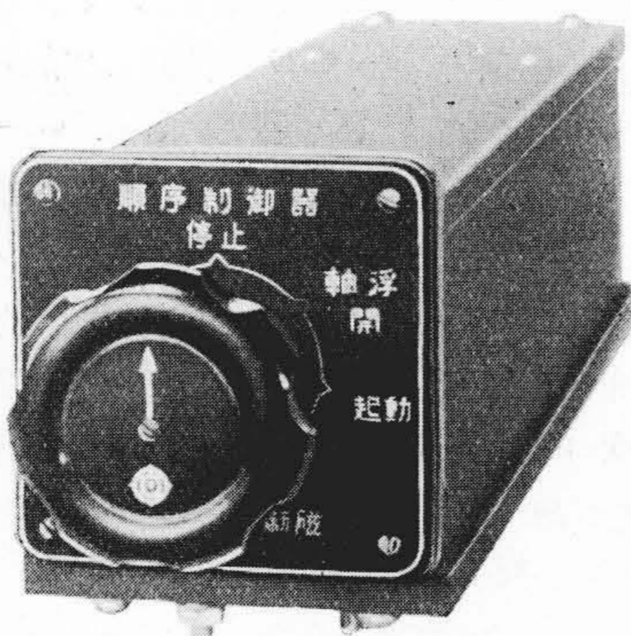
第 13 図 順序 制 御 器 Fig. 13. Sequence Controller
