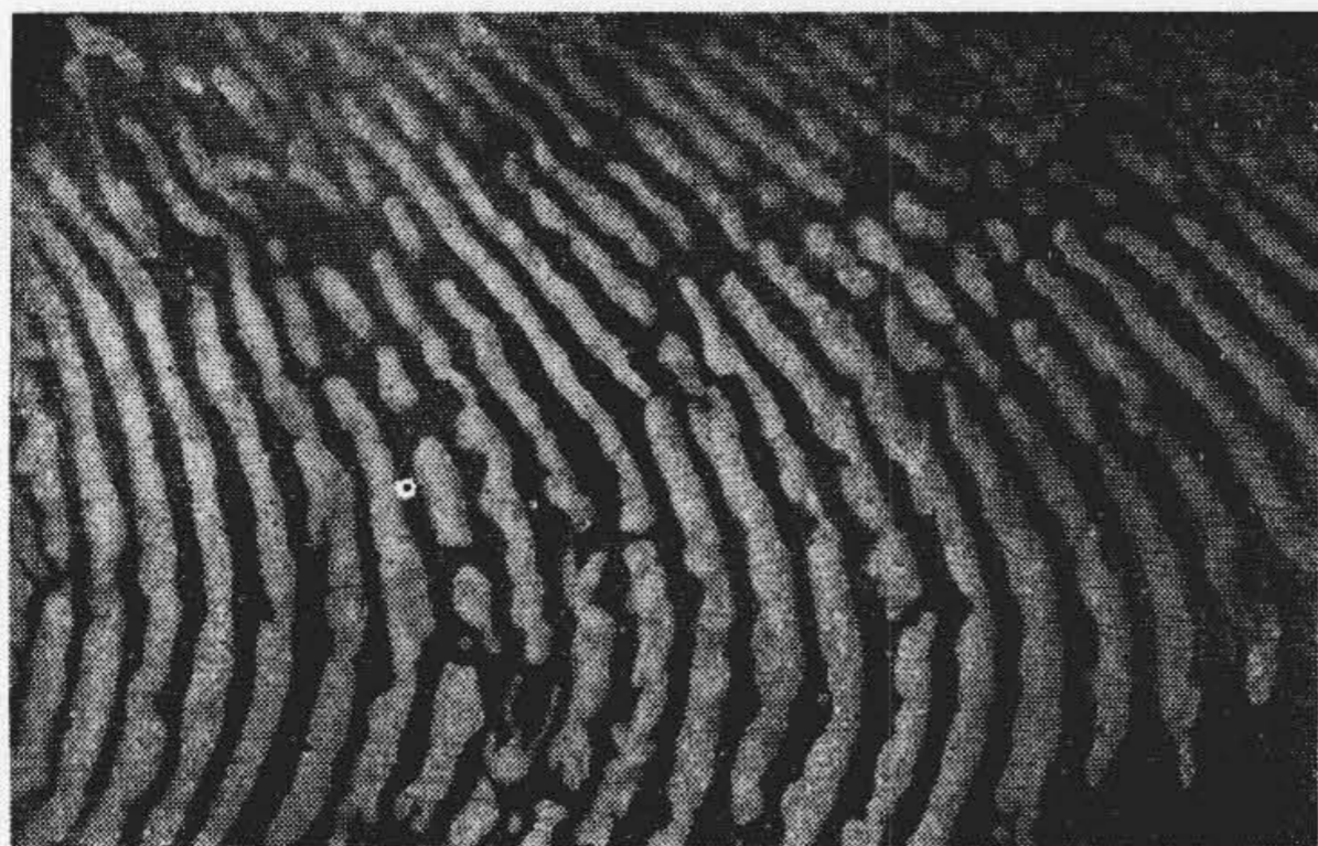
第7図 1.5φダイス孔面の粗さ (仕上ラップ面)
