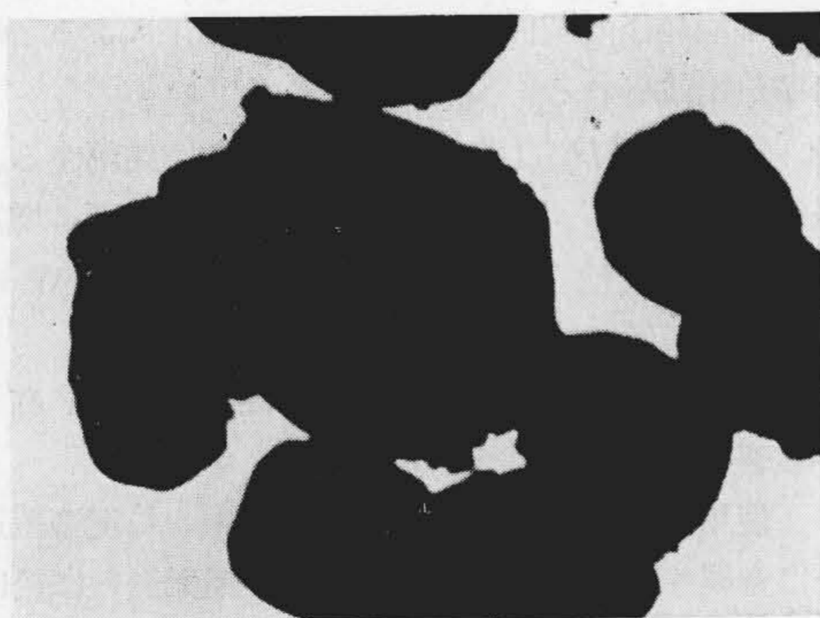
第7図 粗大タングステン粒子 \times 8,000 Fig. 7. Coarse Tungsten Particles
