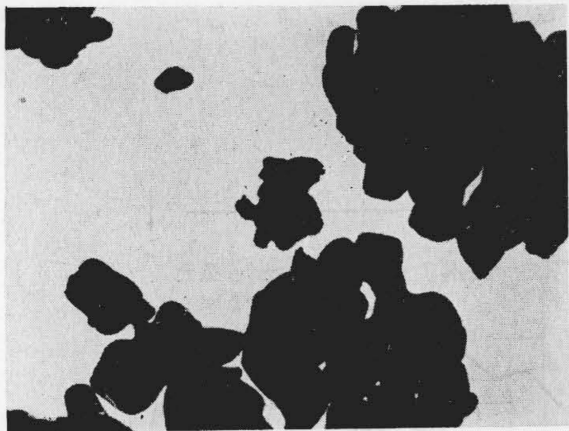
第5図 急速還元による粗大 WO_2 \times 5,700 Fig. 5. Coarse WO_2 by the Rapid Reduction
