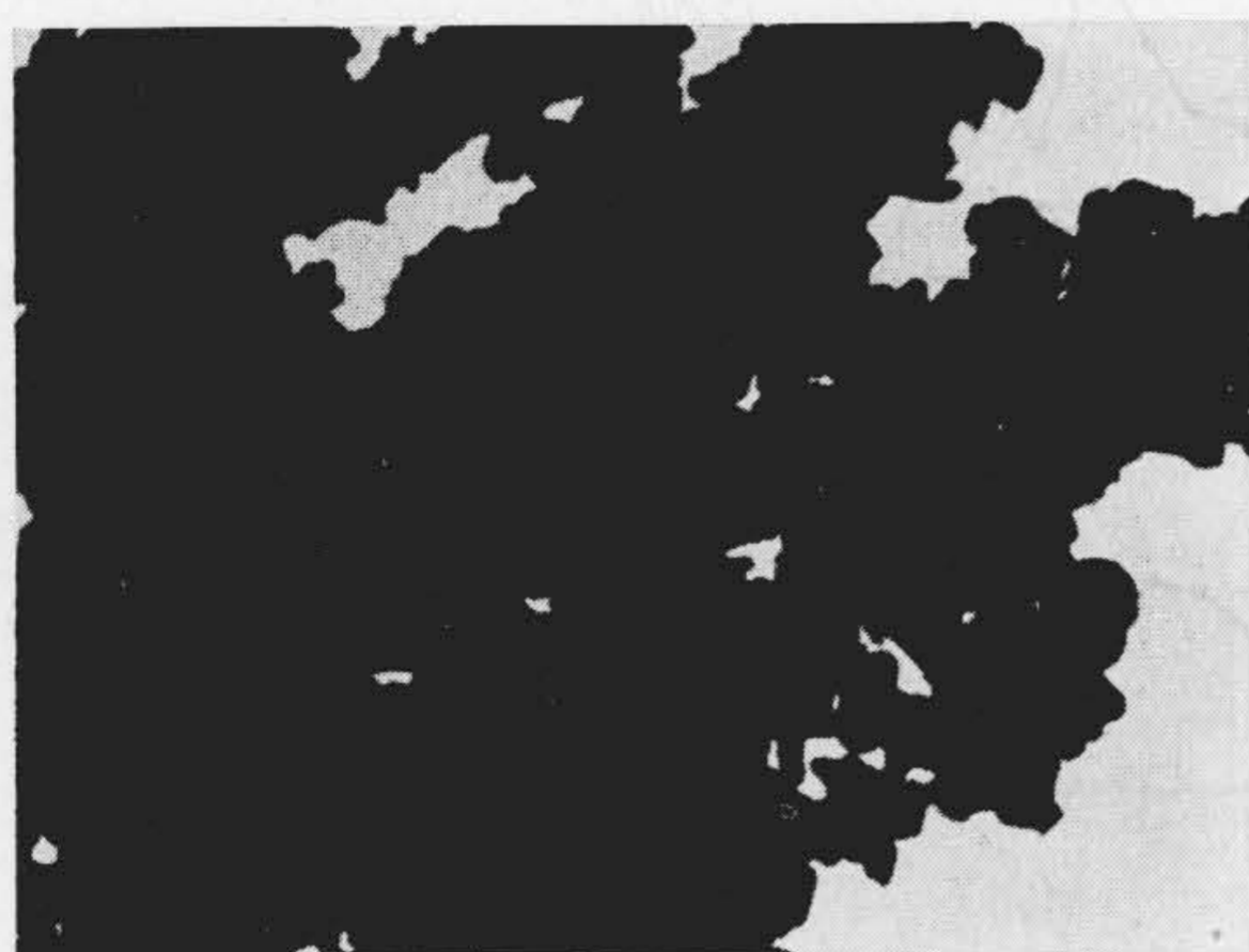
第6図 微細基本粒子から成る凝集粒子 \times 20,000 Fig. 6. Aggregated Tungsten Particles, Consisted by Fine Fundamental Particles
