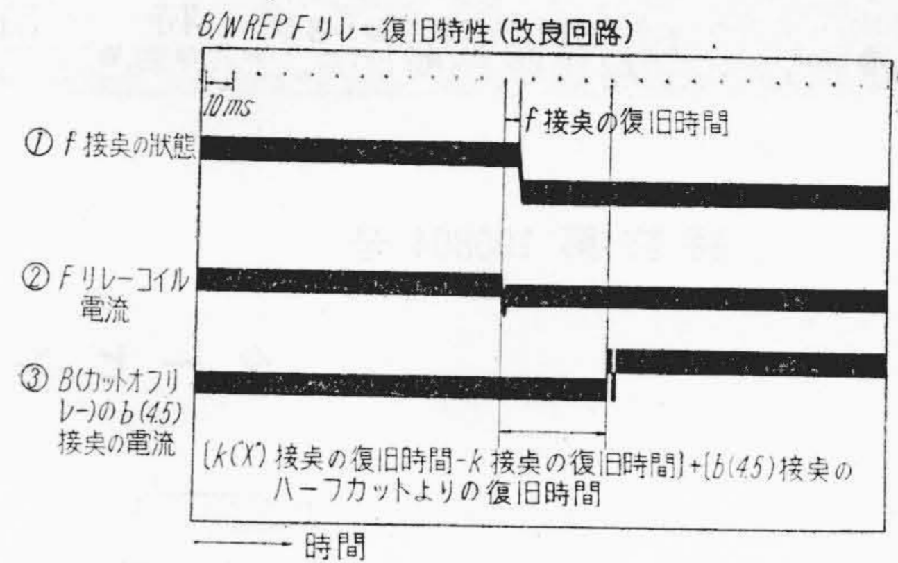
第 8 図 局線用レピータ機能の図式表示 Fig. 8. Demonstration Diagram for Trunk Repeater Circuit Facilities
