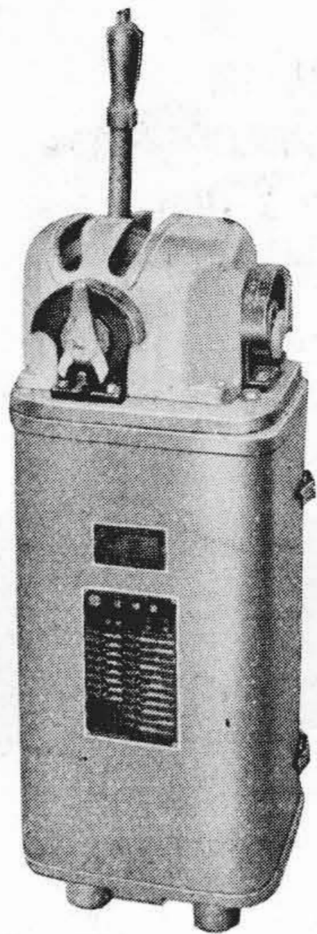
第 66 図 DVU 型 KRR 式主御 幹制御器
