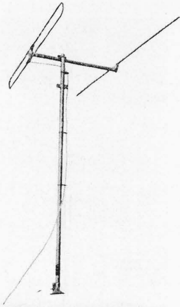
第 50 図 VL-10001 型八木 アンテナ外観図 Fig. 50. View of Type VL-10001 Yagi Array (Folded Dipole with Reflector)
