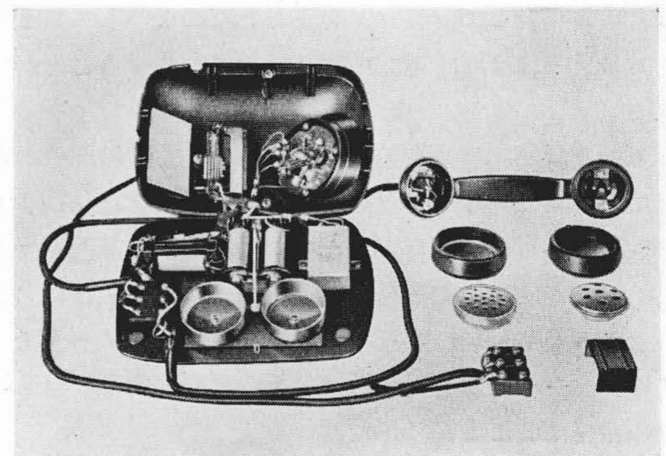
第 11 図 熱 帯 地 用 電 話 機 の 内 部 構 造
