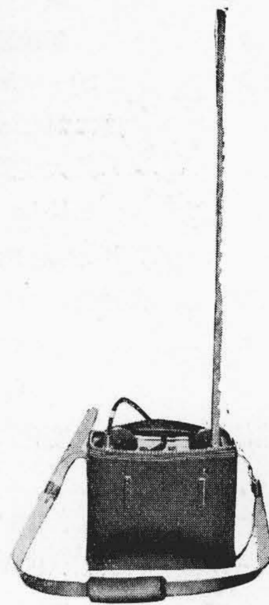
第 42 図 PM-121 型 150 MC ウォークトーカー Fig. 42. Type PM-121 150 MC-FM Walkie Talkie
