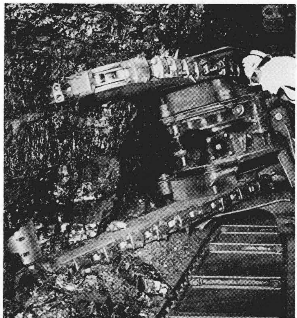
第 7 図 ピルツ付ジブによる透截 Fig. 7. Cutting by Coal Cutter Jib with Piltz
