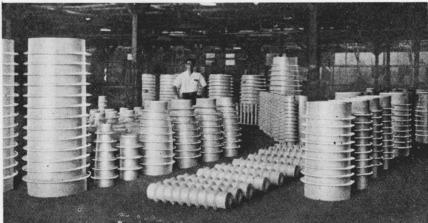
第 5 図 主として鋳込法により作製された種々の碍子碍管類 Fig. 5. Miscellaneous Porcelains Manufactured by Casting Method
