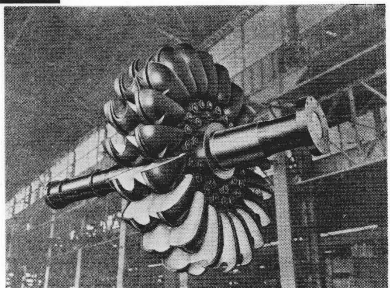
第 6 図 14,250 kW ペルトン水 車ランナー Fig. 6. Runner of 14,250 kW Pelton Wheel
