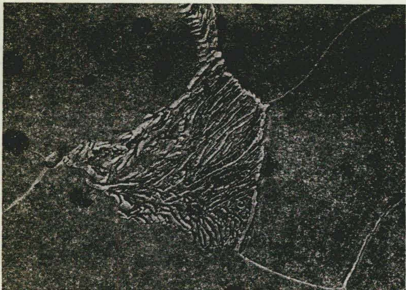
第7図 鋼のパーライト組織 ×2,400 Fig. 7. Pearlite Structure of Steel
