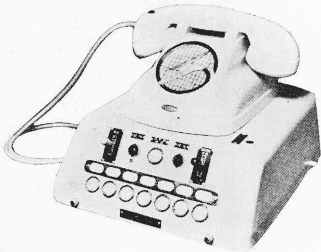
第29図 指令電話機 Fig. 29. Dispatcher Telephone Set of PH-1 Carrier System
