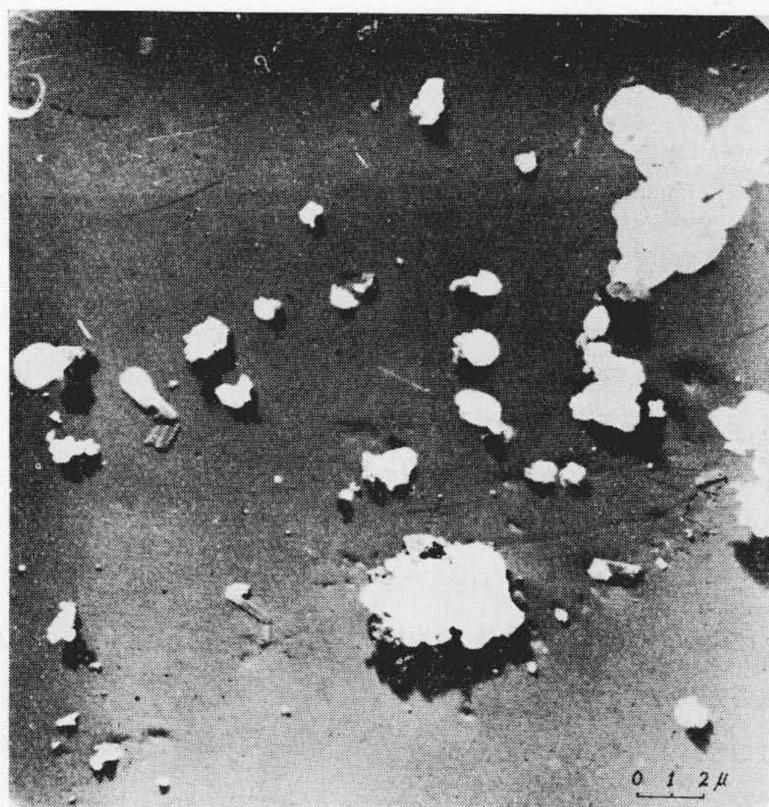
第13図 竹パルプ製造黒液回収に於ける電気集塵ダストの電子顕微鏡写真
