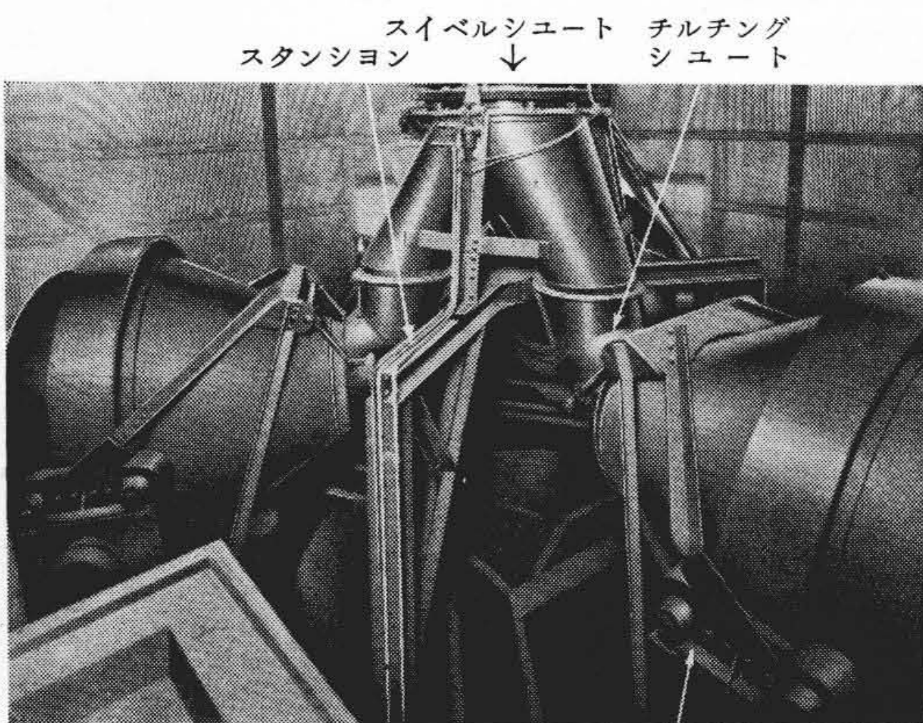
28 切ミキサ 第 8 図 混 練 設 備
