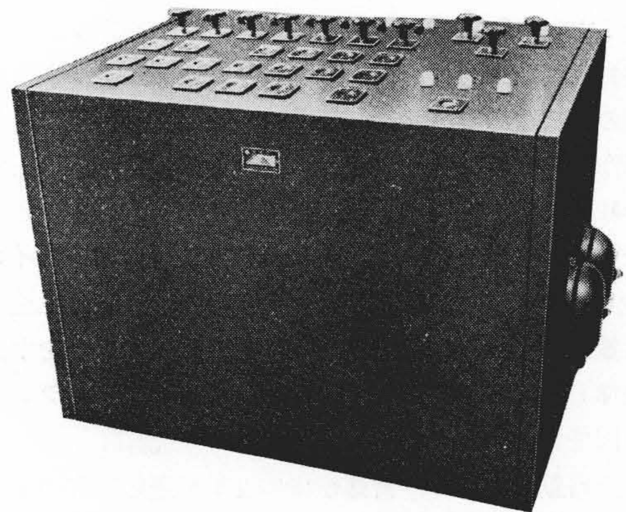
第12図 計量係操作盤 Fig.12. Batcher Control Desk with Indicating Signal
