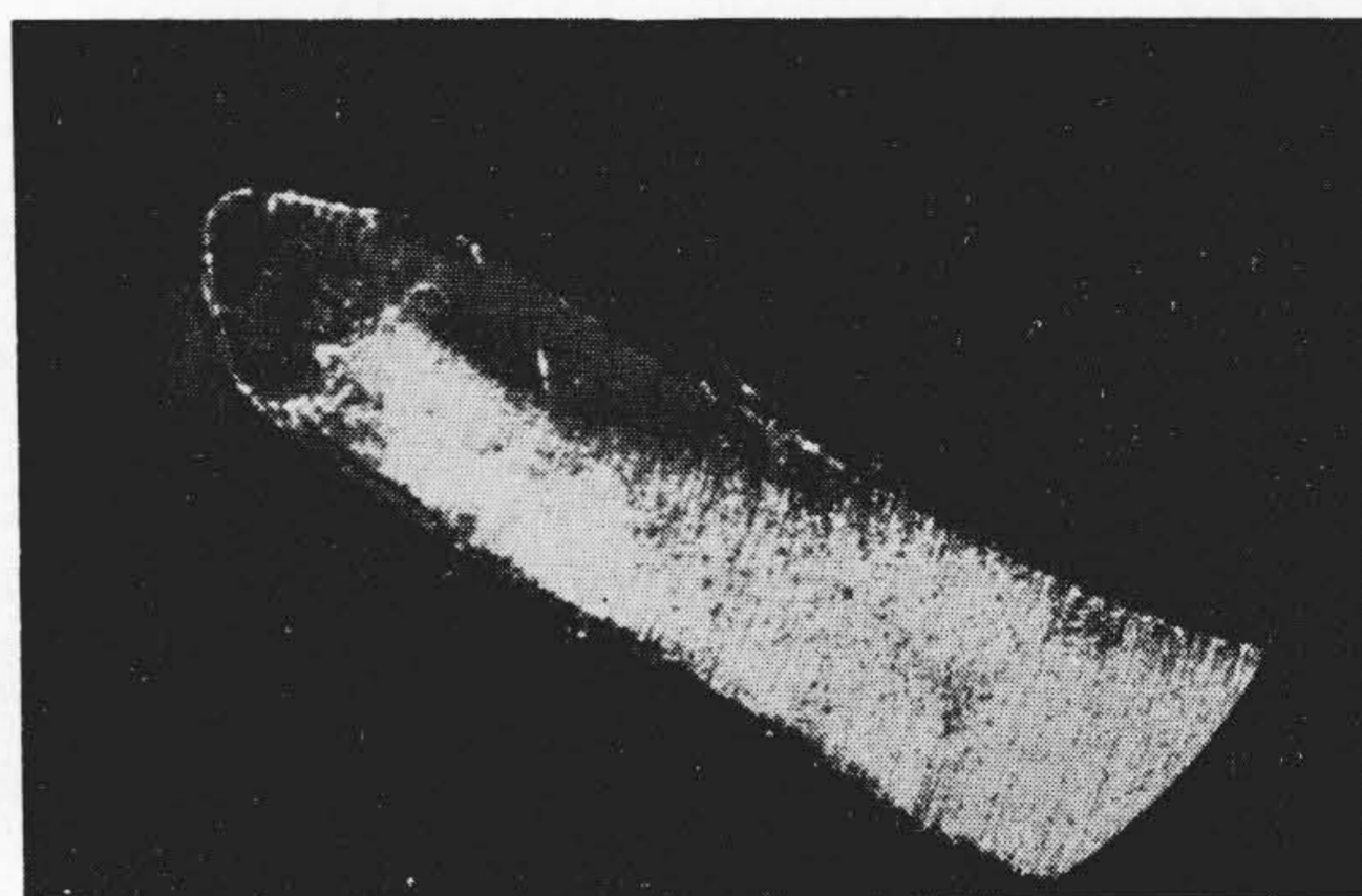
第16図 寿命試験後の爪 Fig. 16. Pawl after Life Test
