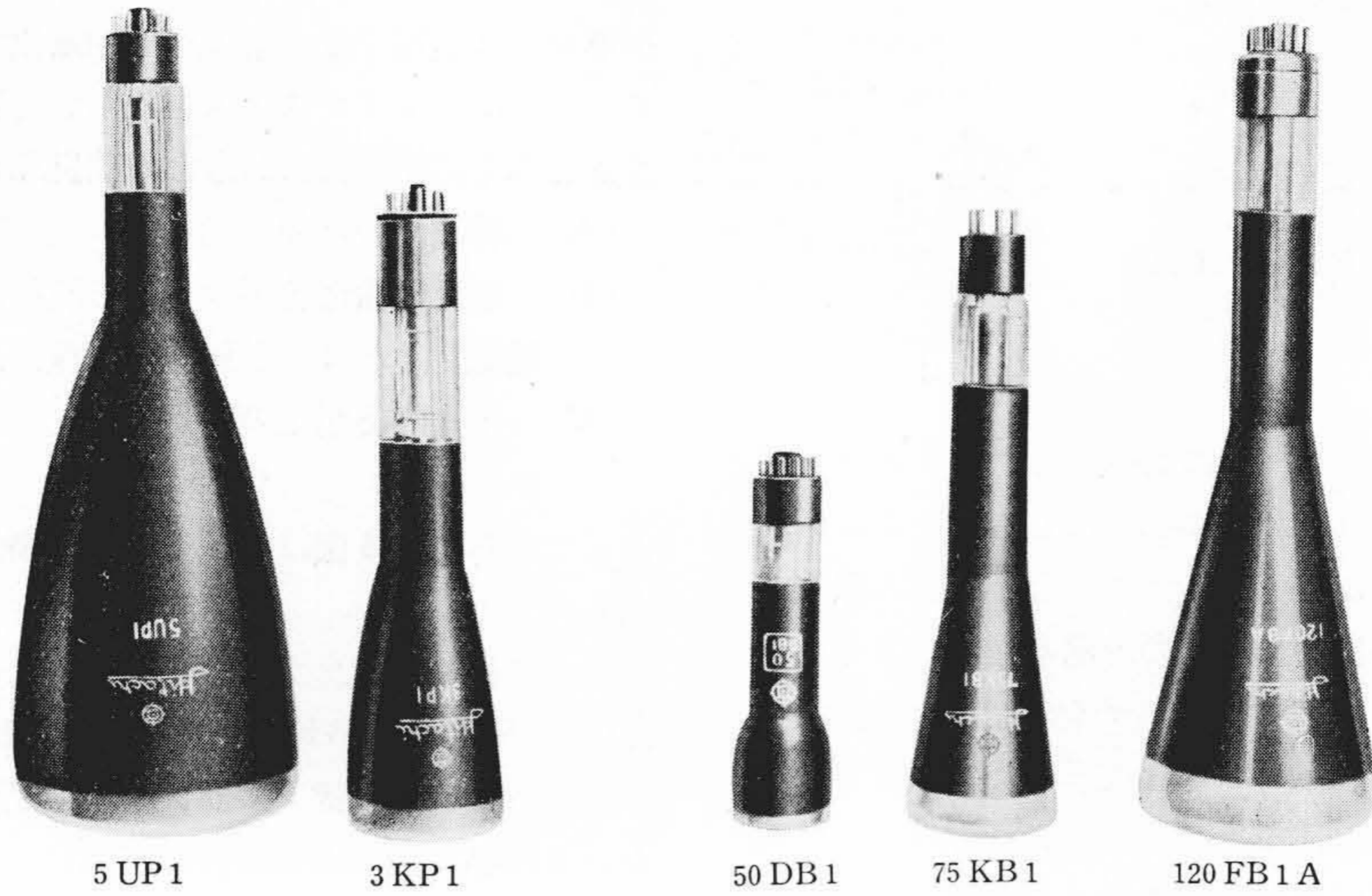
第6図 各種観測用ブラウン管の外観 Fig.6. Outline of Cathode Ray Tubes
