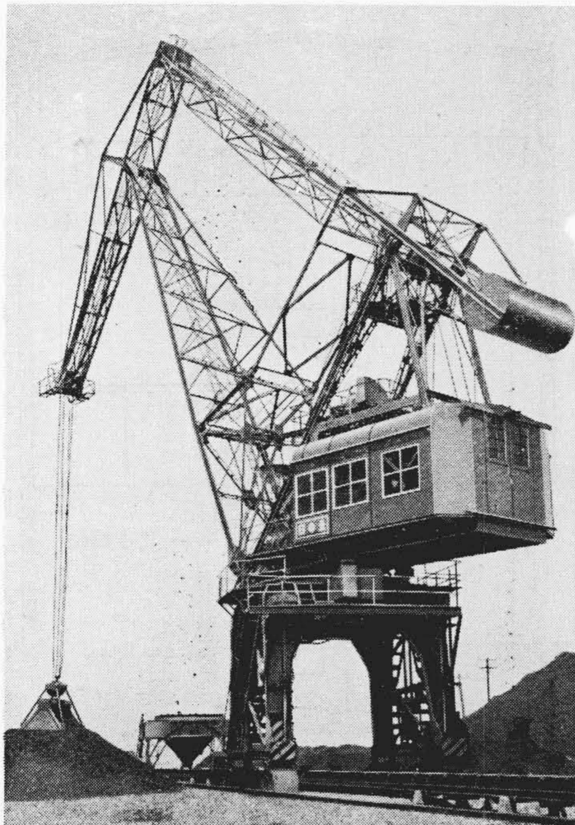
第14図 5t×25m 水平引込クレーン Fig.14. 5t×25m Level Luffing Crane with Grab Bucket
