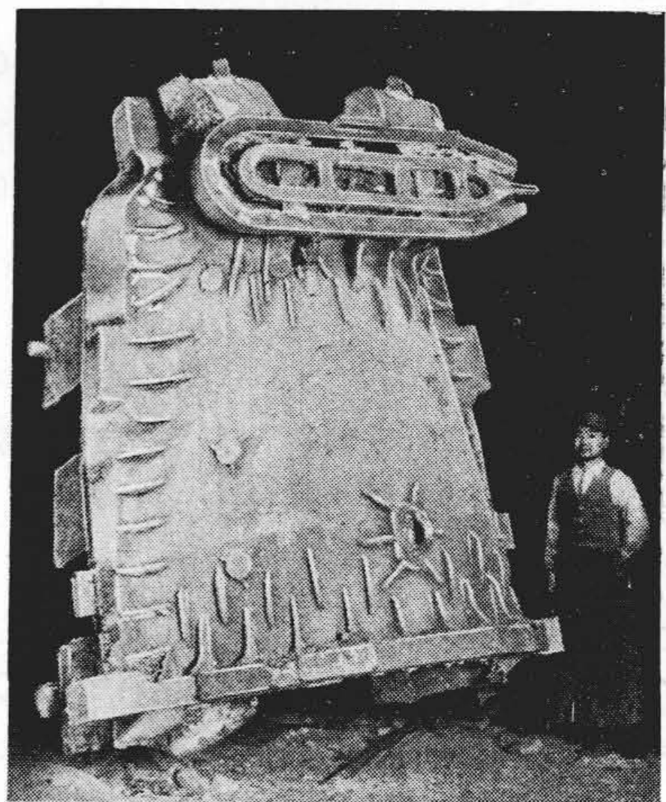
第44図 特殊鋼鋼製大型タービン高圧ケーシング Fig. 44. Steam Turbine Highpressure Casing Made of Special Steel
