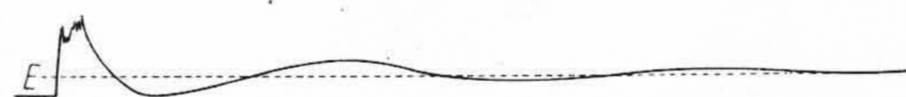
第 9 図 安 定 時 の オ シ ロ グ ラ ム Fig. 9. Oscillogram of Non-Hunting
