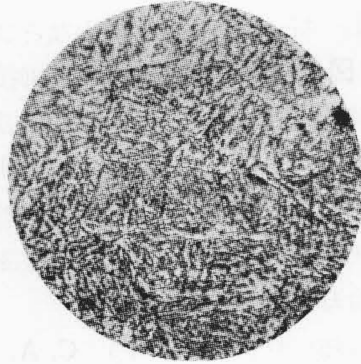
第14図 1% Cr 1% Mo 鋼の顕微鏡組織 冷却速度: 80°C/分 ×450 Fig. 14. Microstructure of 1% Cr 1% Mo Steel Cooling Rate: 80°C/min ×450
