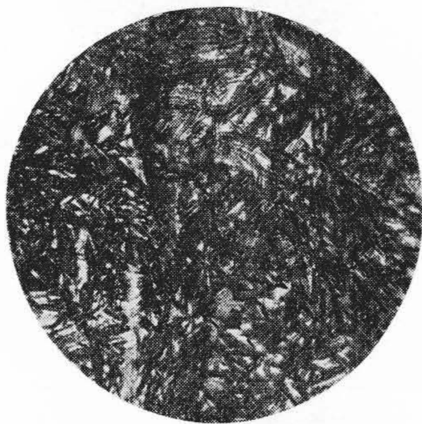
第21図 試料 No.14 火焰硬化部分組織 ×400 Fig. 21. Quenched Structure of No. 14 After Flame Hardening
