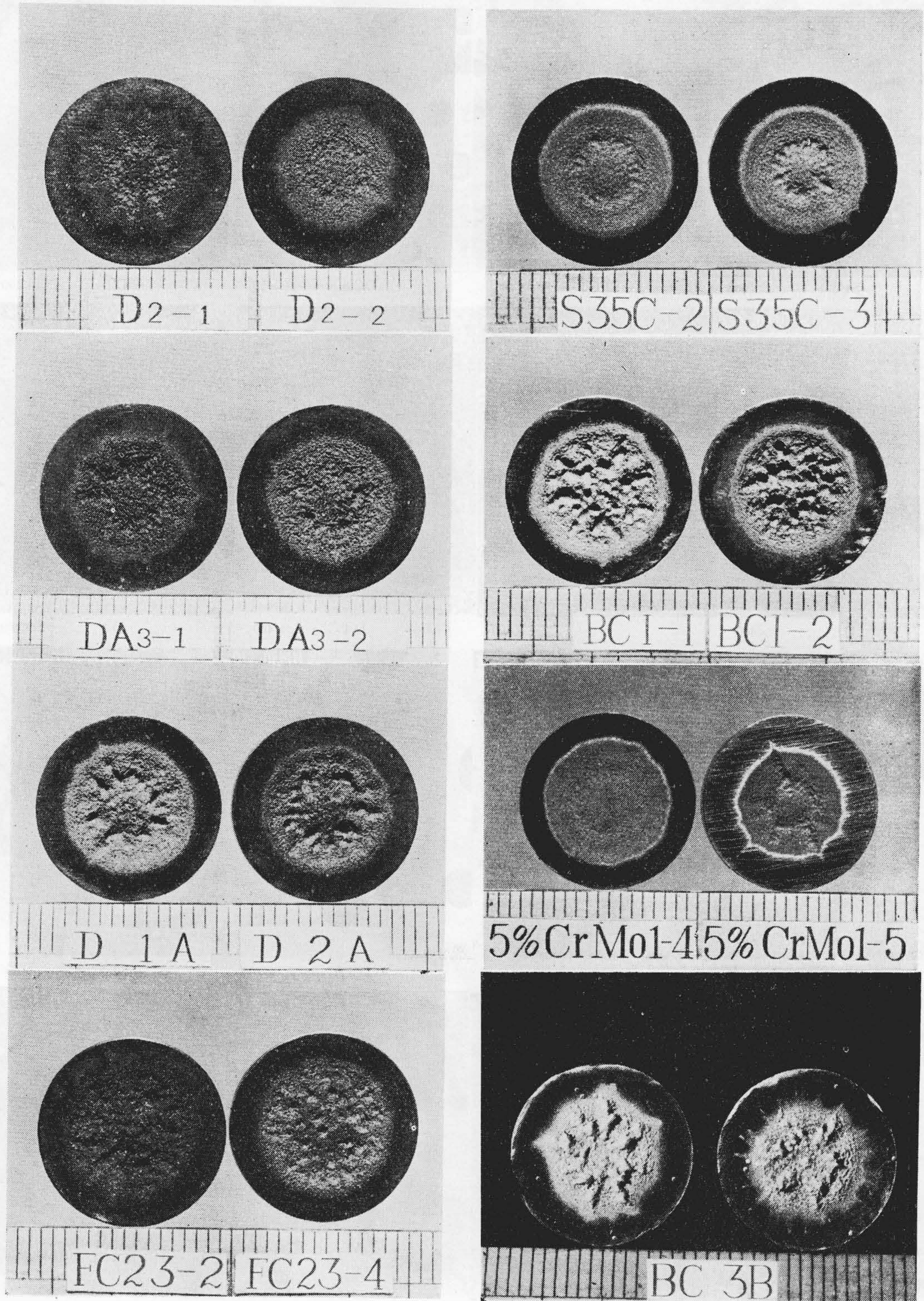
第8図(b) キャビテーション・エロージョン試験後の潰蝕面
