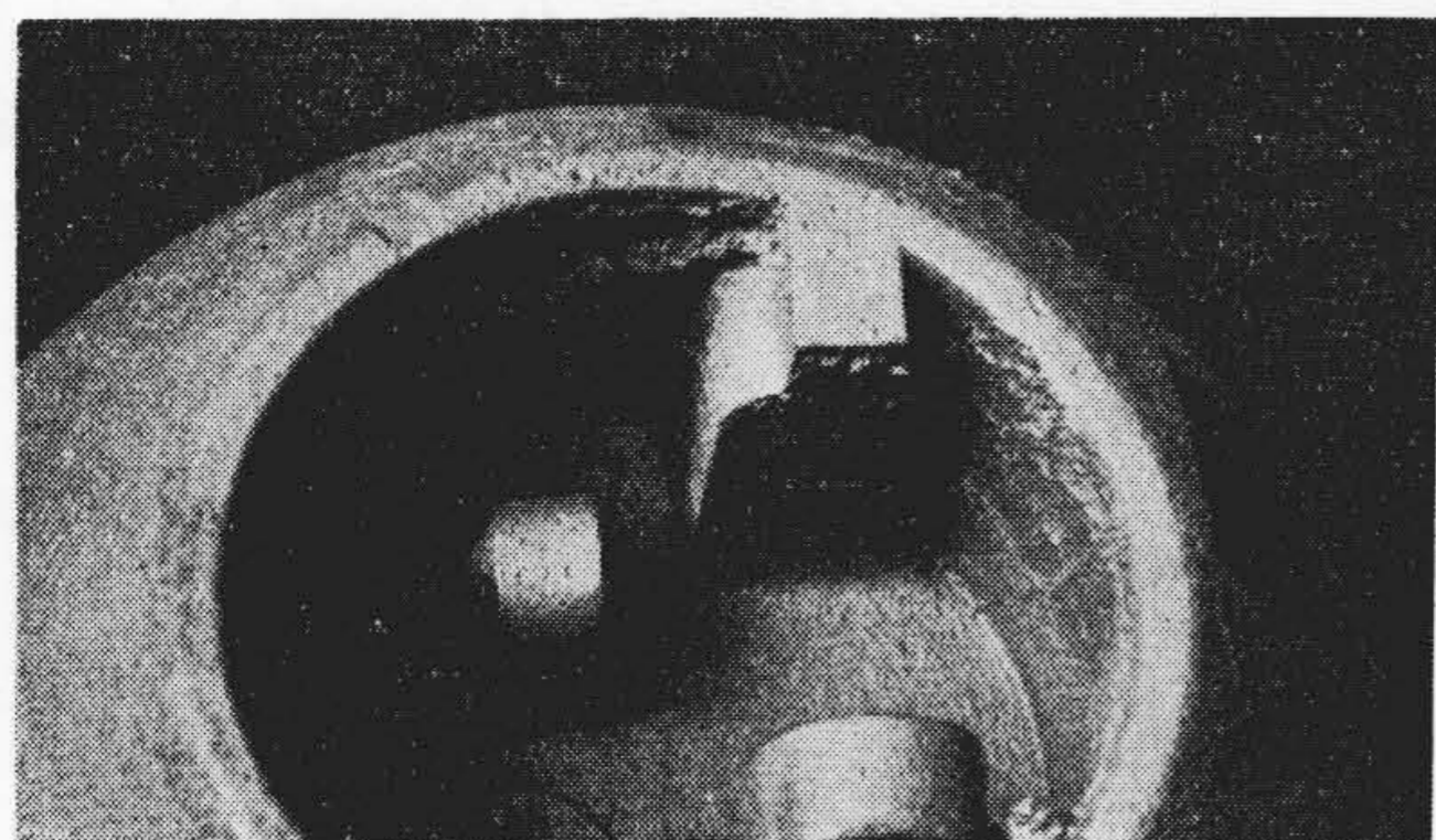
第15図 レジン砂の充填不完全なシェルに 鋳込まれた鋳物の表面欠陥
