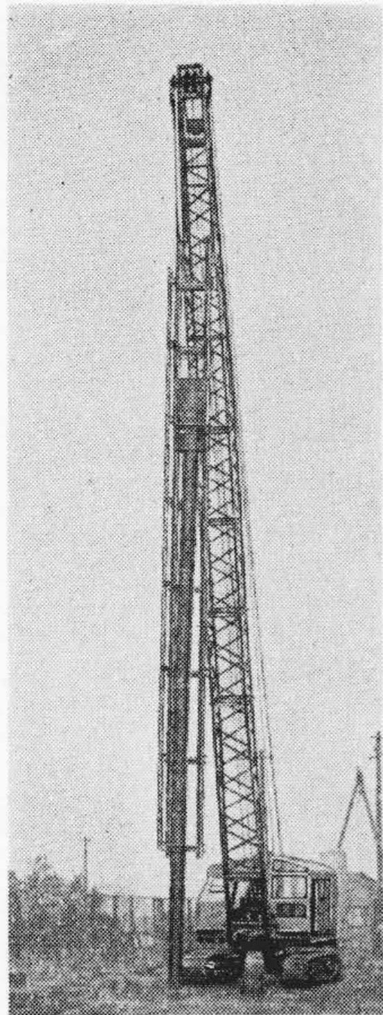
第5図 U06ロングブーム パイルドライバ (ハンマ重量1.5t, ブーム長さ19 m, 杭の長さ最大15m, 原動機実 用最大出力100HP)
