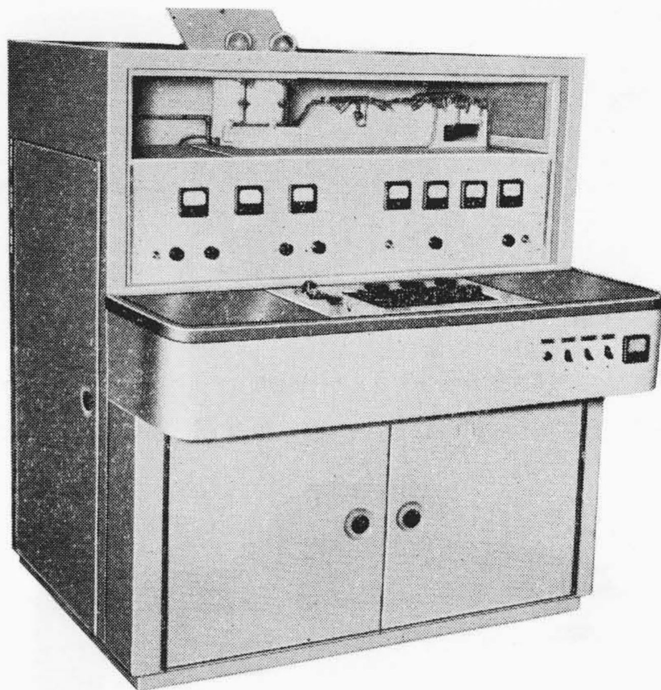
第3図 世界ではじめて商品化された重水用質量分析計
