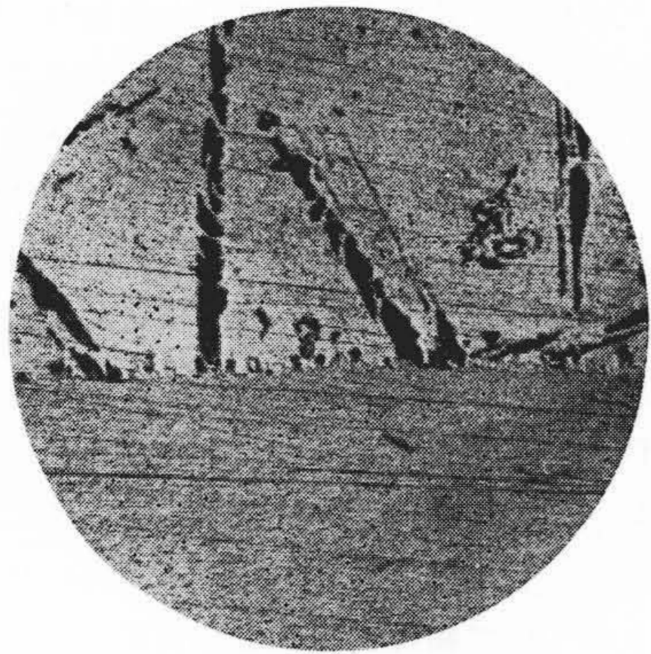
第8図 鋳接部の顕微鏡組織 × 100 (鋳：Sn—20% Zn 合金)
