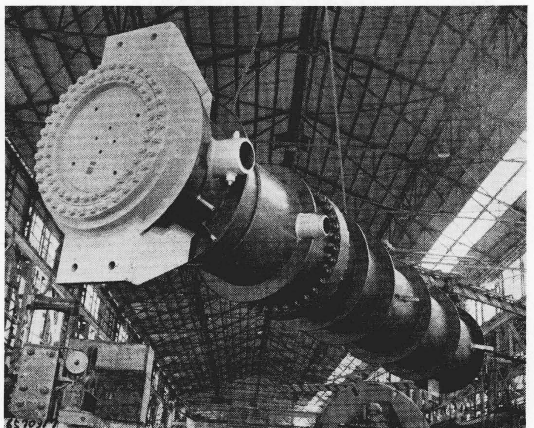
第6図 高圧給水加熱器
