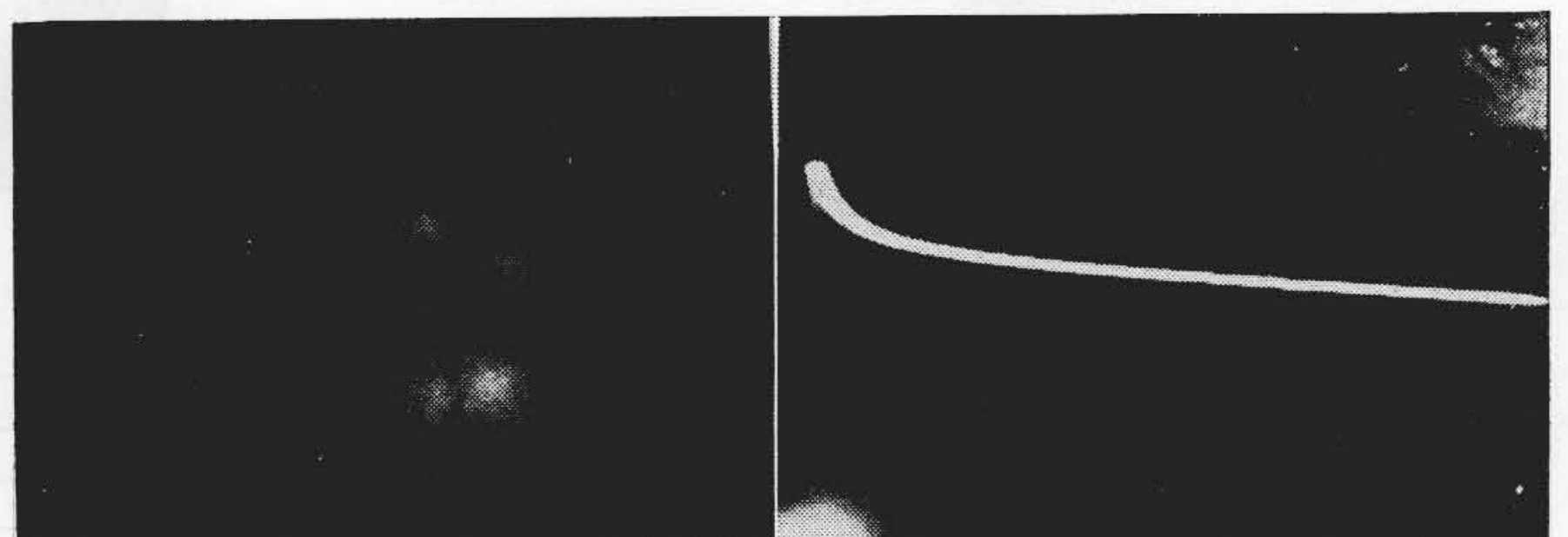
ボイド径=9 mmφ 第1図 インパルス電圧印加時の放電図形およびコロナパルス
