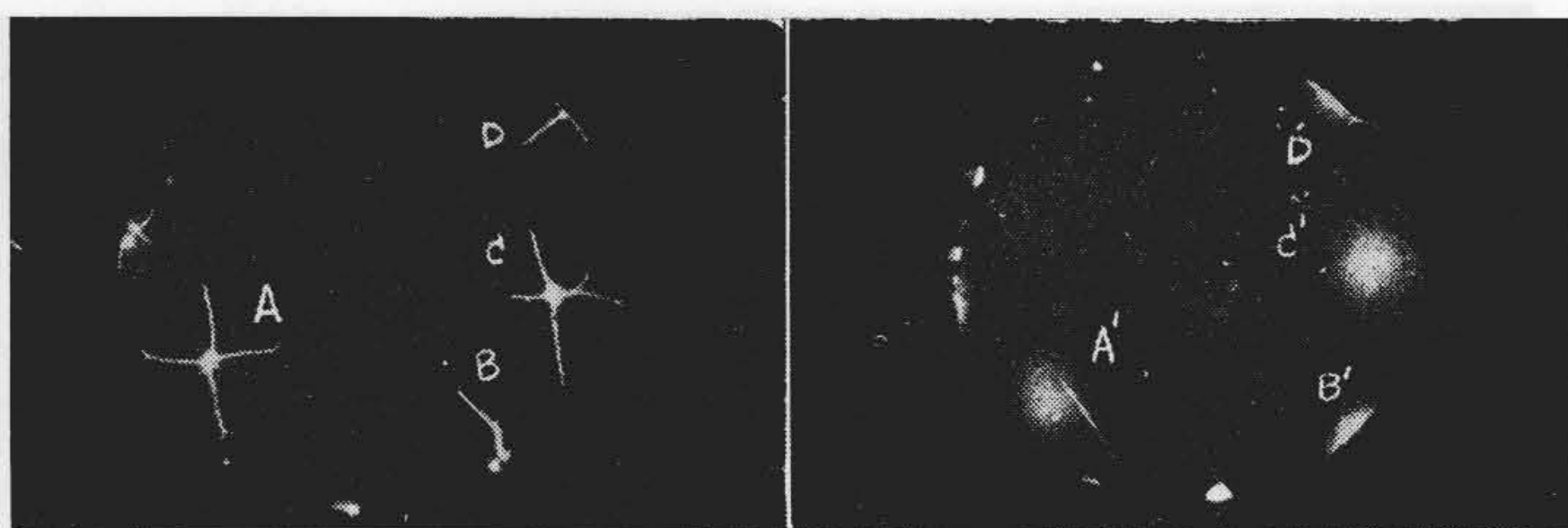
(A) 正放電図形 (B) 負放電図形 ボイド径=9mm
