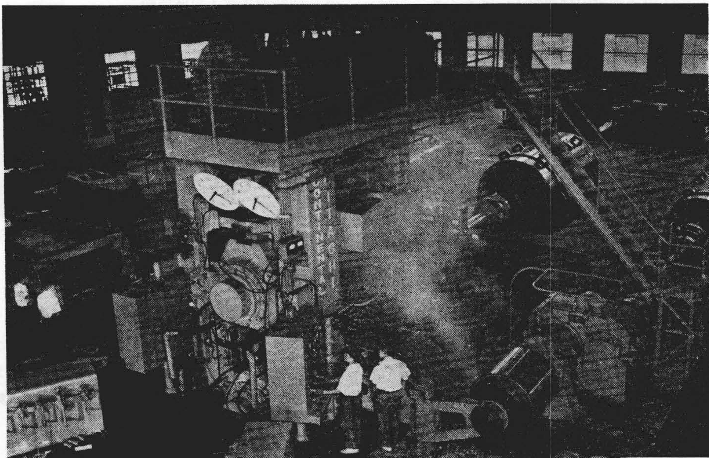
第1図 49"/16.5"φ×46" L 可逆式四重冷間圧延機の稼働状況
