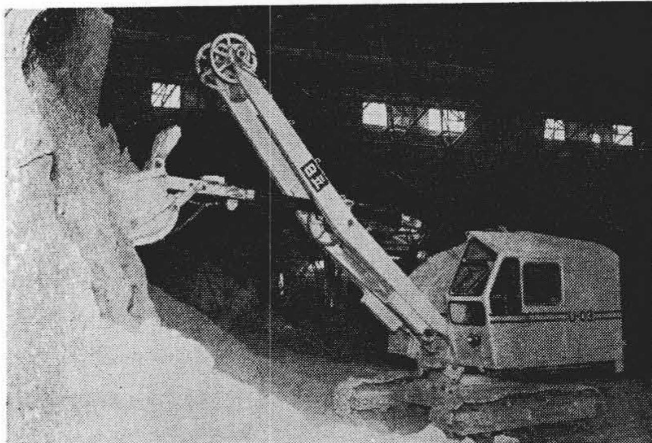
第1図 過磷酸石灰積込みに活躍する U03 ショベル (0.4 m 3 のジップ装備)
