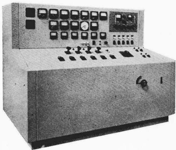
第12図 ファンデグラフ加速器用制御盤
